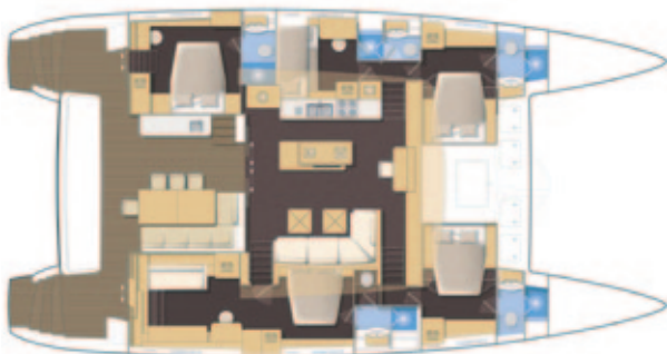
Cuisine centrale / Central galley - Version propriétaire 5 cabines - Owner's version, 5 cabins.
