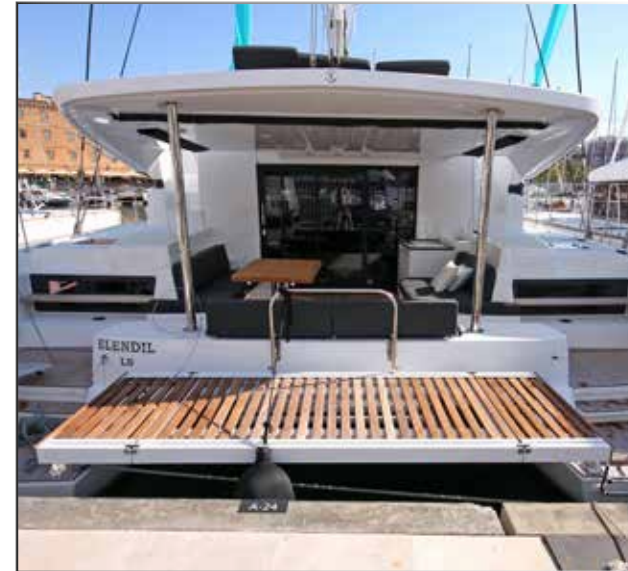
TENDERLIFT MIT AUSGEKLAPPTEN FLÜGELN
