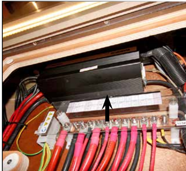
SPANNUNGSWANDLER 12 V / 220 V - 2000 VA
