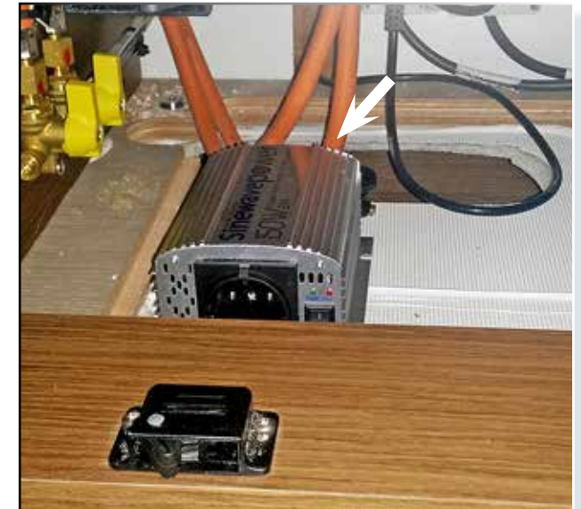
SPANNUNGSWANDLER 12 V / 220 V - 150 W
