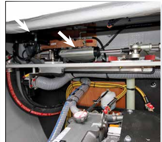
PUMPE + STEUERZYLINDER DES AUTOPILOTEN
