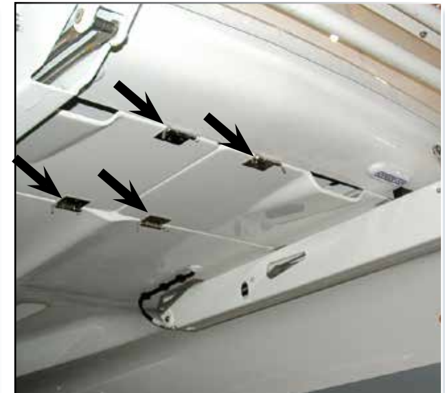
BLOCKIERSYSTEM DER ZUGANGSKLAPPEN ZU DEN RETTUNGSINSELN
