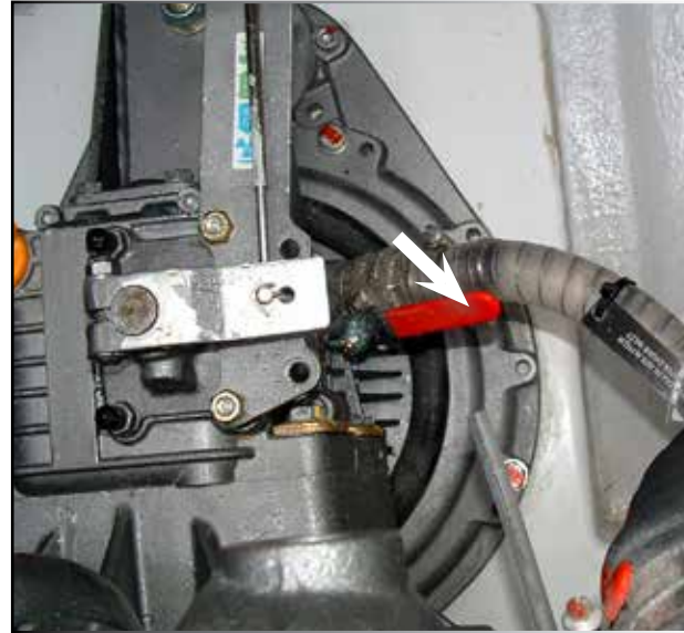
WASSERANSCHLUSS DES MOTORS
