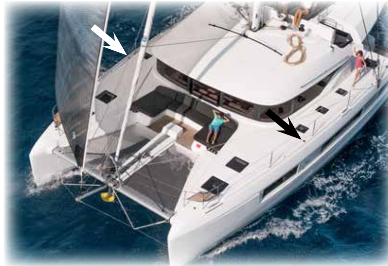
DECKANSCHLÜSSE DER FRISCHWSSERTANKS
