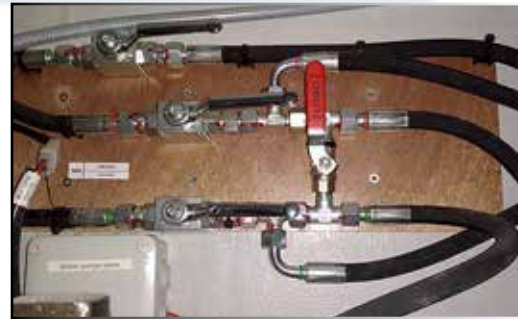
HYDRAULIKZYLINDER DER PINNE BYPASS-POSITION
