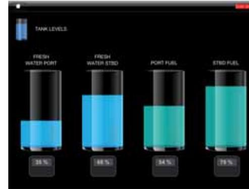
Menü Tanks (zur Kontrolle der Füllstände in den Wasser- und Kraftstofftanks)
