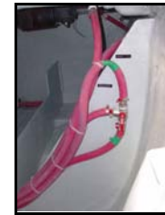
Auswahlventil - Süßwasser / Seewasser (Kennnummer 2)
