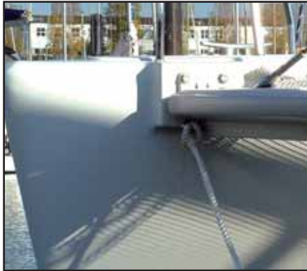
BEFESTIGUNG DES HAHNEPOTS AM VORDERHOLM
