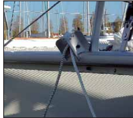
DURCHFÜHRUNG DES HAHNEPOTS DURCH DIE BUGROLLE
