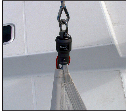
BEFESTIGUNG DES GENNAKERFALLS AM WIRBELLAUGE DES GENNAKERKOPFES
